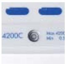
Пузырьковый уровень находится на передней панели прибора для более простого регулирования
